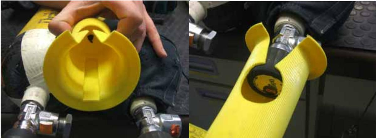
Bild 2 und 3: Schutzkappe für die Pressluftflasche
